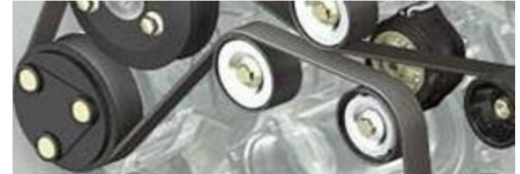
Привод навесных агрегатов двигателя MC13 производится одним поликлиновым ремнем
